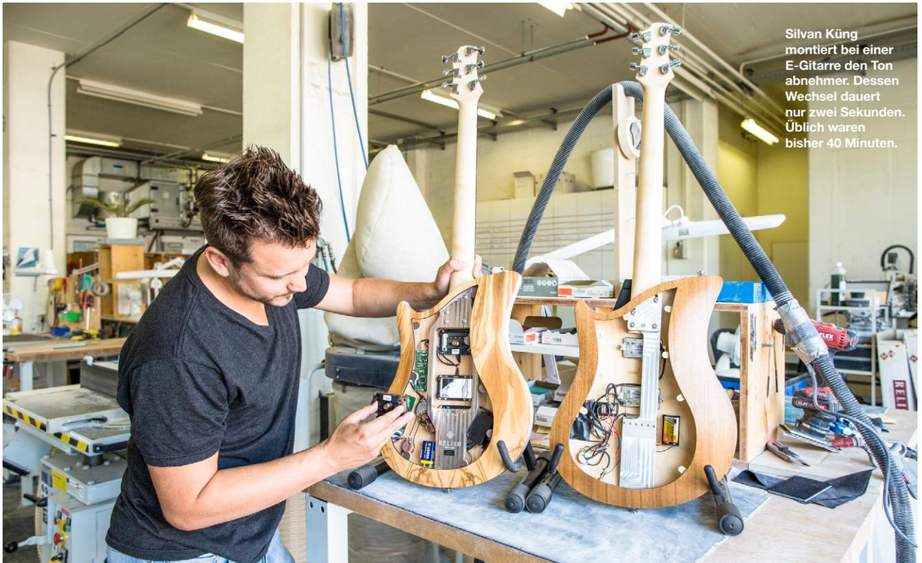
Silvan Küng montiert bei einer E-Gitarre den Ton abnehmer. Dessen Wechsel dauert nur zwei Sekunden. Üblich waren bisher 40 Minuten.
