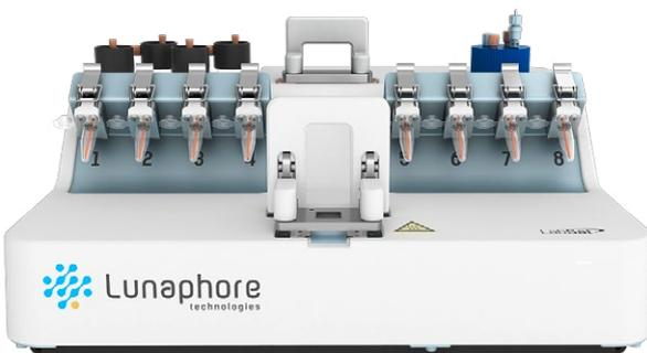
Gewebediagnosesystem Labsat auf Basis der preisgekrönten, hochpräzisen Mikrofluidiktechnologie. Dank dieser dauert die Analyse von Gewebeproben statt mehrerer Stunden nur noch maximal 30 Minuten – und ist erst noch präziser durchführbar. Lunaphore hat bislang zahlreiche Auszeichnungen gewonnen, unter anderem mehrfach den Top 100 Swiss Startup Award. [lunaphore.ch](http://lunaphore.ch)
