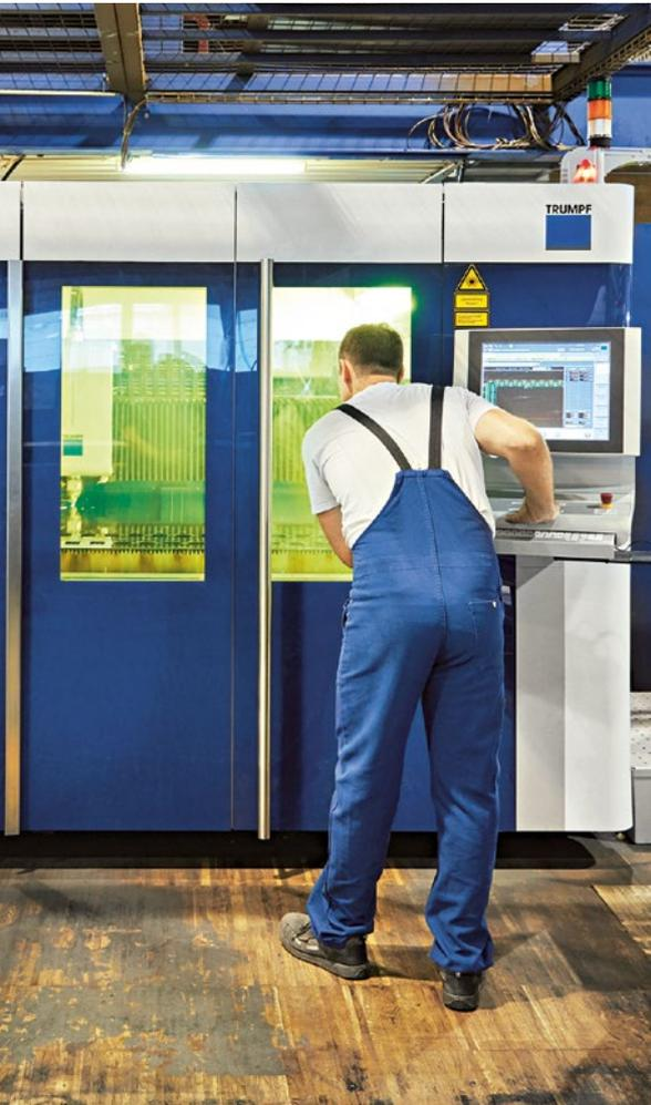
Ein Mitarbeiter überwacht vom Monitor aus den Laserschneider, dessen Kopf in einem geschlossenen «Container» bewegt wird.
